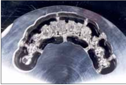
Fig. 86 Fresature a pieno prive di saldatura e prive di micro porosità
